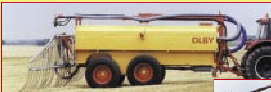
Tankvagnen är extrautrustad med OLBY sugkran och Harsö slangspridarramp.
