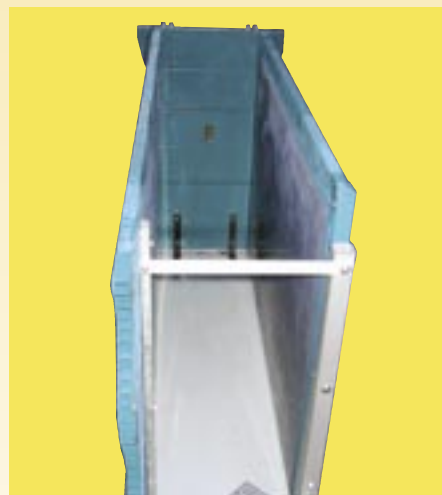
Vikten registreras när grisen förändrar det elektriska fältet mellan två kopparplåtar.
