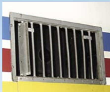
Luftriktare (t v på bilden) på bilens ventilationsöppningar ger bättre luftrörelser och avkylning av grisarna under varma dagar.
