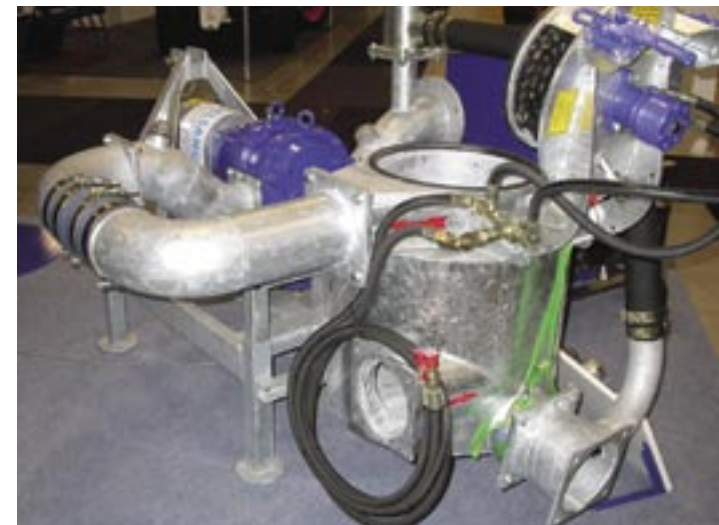
Bilden t v: Stenficka är ett viktigt tillbehör för att undvika pumpskador.
