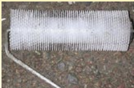
Taggad roller för att bli tag bort luftblåsor i materialet i samband med utläggningen av materialet.
