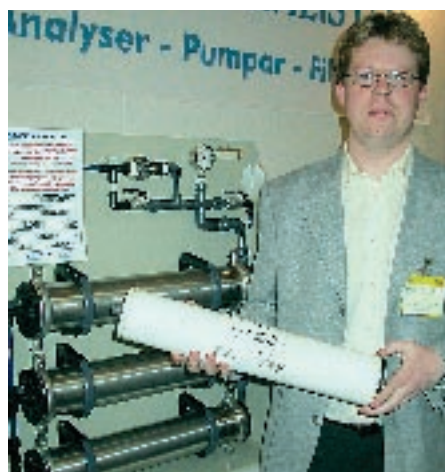
Jonas Ohlson visar ett filter till RO-anläggningen, som syns på väggen. Det klarar 300 liter per timma.
