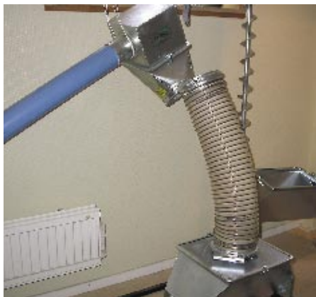
Förbindelse mellan olika skruvar. En för 80 ton har en diameter på 20 cm.
