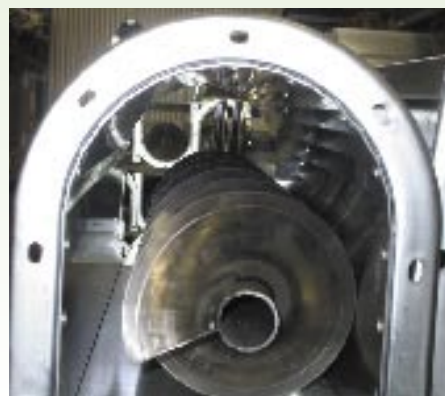
Närbild av en öppen skruv, upp och nervänd, som tillverkas vid Rotage Agri.
